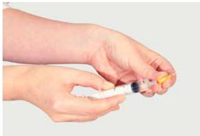
将点胶针头套在注射器上
