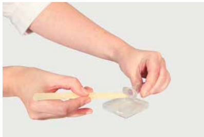
为确保用量精准，请将已混合的胶水倒入注射器
